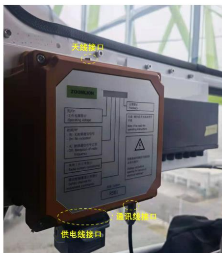
图 7-20 接收机安装示意图
